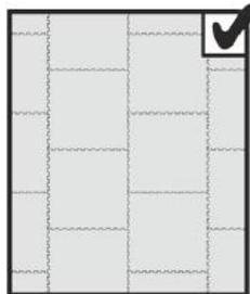
Zu den Wänden hin wird eine Fuge von 5 mm gelassen. Die lose Verlegung ist auf 150 m<sup>2</sup> begrenzt. Größere Flächen müssen entsprechend aufgeteilt und jeweils zwei Fliesen übergreifend verklebt verlegt werden. Hierzu kann entweder ein extra breiter doppelseitiger Klebeband oder ein anderer geeigneter Klebstoff verwendet werden.
